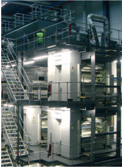
Druckmaschinen mit größeren Formaten und Direktantrieben benötigen weniger Energie und produzieren weniger Abfall. Foto manroland.
