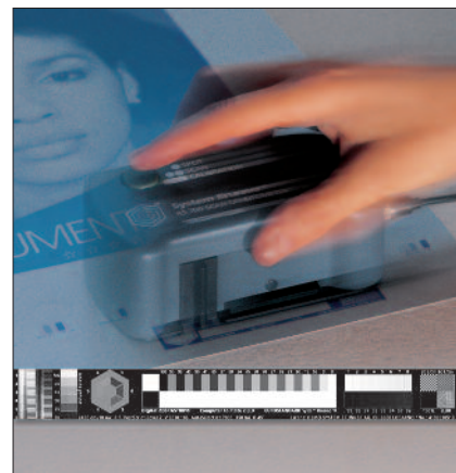
Mesure de la plaque à l'aide d'un scanner à plaques sur une gamme de contrôle numérique appropriée. Les lecteurs de plaques sont également largement répandus pour la mesure de la plaque (ex X-rite ccDOT, Techkon DMS). Photo: System Brunner.
