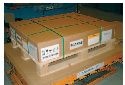
Il trasporto delle lastre richiede un imballaggio specializzato per la loro protezione contro i danni da trasporto e umidità. La protezione del rivestimento delle lastre è assicurata mediante interfolgi di carta. Una minore movimentazione delle singole scatole riduce anche i rischi dei danni da trasporto. Foto: Kodak GCG
