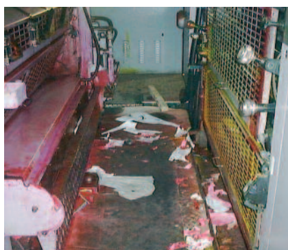
Mantenere le aree di lavoro pulite e ordinate. Se non adeguatamente controllata, la polvere di carta contamina gli inchiostri e le lastre. Ridurre al minimo le esigenze di pulizia riducendo la nebbia d'inchiostro.
